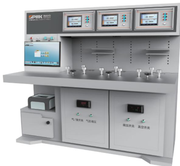
SPMK2033N全自动综合压力校验台运用数字控制技术，是我公司研制的三合一全自动智能压力校验台。全程采用全智能控制，多量程自动造压，快速输出高精度和高稳定度的压力；是集造压、测试、采集、处理为一体的全自动智能压力控制器校验台。帮助工作人员高效、高质、安全的完成指针式仪表、压力变送器、压力开关等仪表的快速检定、校准工作。利用HART、Profibus功能可以完成HART压力变送器、Profibus变送器的校准工作。
