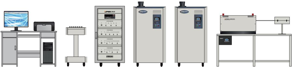
SPMK3001群炉温度自动检定系统，是由计算机、打印机、六位半或七位半高精度数字多用表、两级低电势扫描控制器、RS485接口、高精度温度控制仪表、水槽、油槽、管式检定炉和专用软件等组成的自动控制与测试系统，是集计算机技术、微电测技术和自动测试技术于一体的智能化计量标准装置。该系统用于自动检定/校准各种工作热电偶和热电阻，可同时控制(1~4)台管式检定炉和1台水槽或油槽(热电偶、热电阻能同时检定/校准)，每台管式检定炉一次可检定/校准(1~10)支热电偶，每台水槽或油槽一次可检定/校准(1~10)支热电阻，能满足短时间内检定/校准大批量热电偶和兼容热电阻的检定/校准要求。系统采用了本公司多项技术创新成果，其软、硬件均由本公司独立开发并拥有完全自主知识产权。系统硬件结构方式采用标准化结构，方便系统维护和升级，具有方便、可靠的系统可扩展性。系统具有设计结构合理、软件功能齐全、操作方便、量值传递准确可靠、抗干扰能力强、组态灵活等一系列特点。能实现自动数据采集、处理、表达、传送、存储和文档管理及自动生成检定/校准证书等功能，利用本系统可大大提高工作效率。
